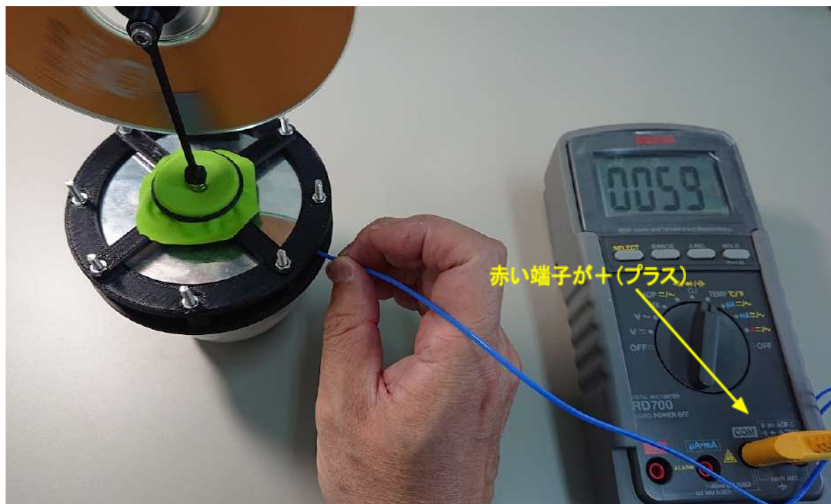
図10 デジタルマルチメータと温度センサの使用法
