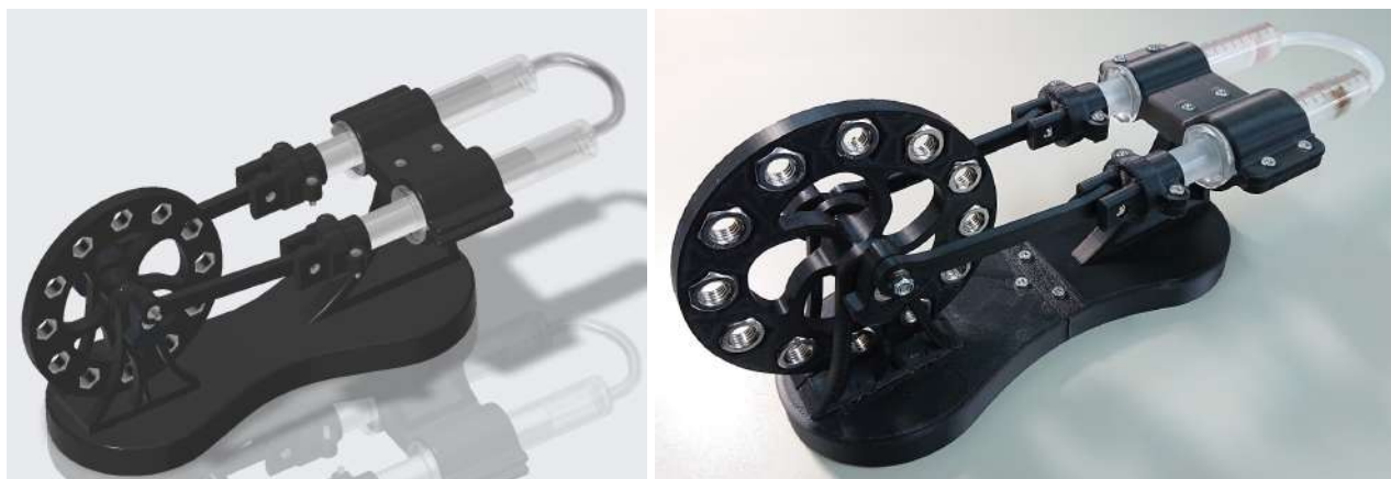
図3 \alpha 型スターリングエンジンキットの3Dモデル(左)と完成品(右)
