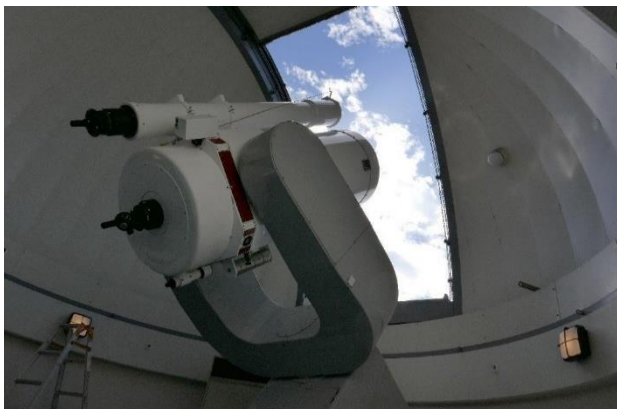
図1 口径60cmカセグレン式反射望遠鏡
